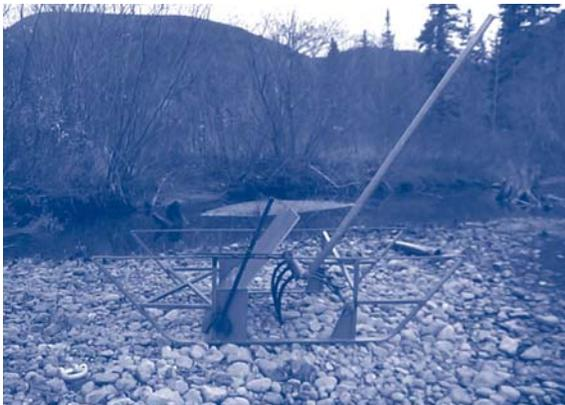
Prototype d'un nouvel instrument visant à réduire la quantité de sédiments fins dans le substrat des frayères. (photo: Mylène Levasseur)
