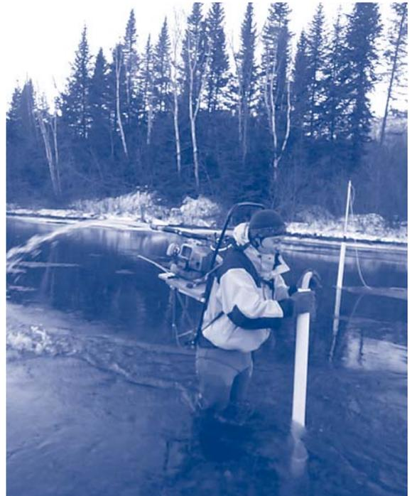
Mesure de la vitesse d'écoulement intergranulaire dans le substrat de fraie sur la rivière Sainte-Marguerite (photo: Francis Bérubé)
