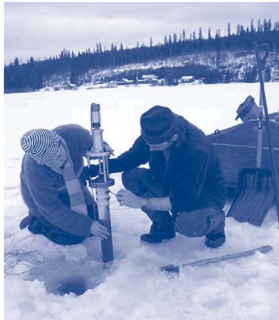
Forage des sédiments lacustres à l'aide d'un carottier (printemps 2004, lac Huard, rivière Cascapédia). (photo: Jean-François Bisailon)
