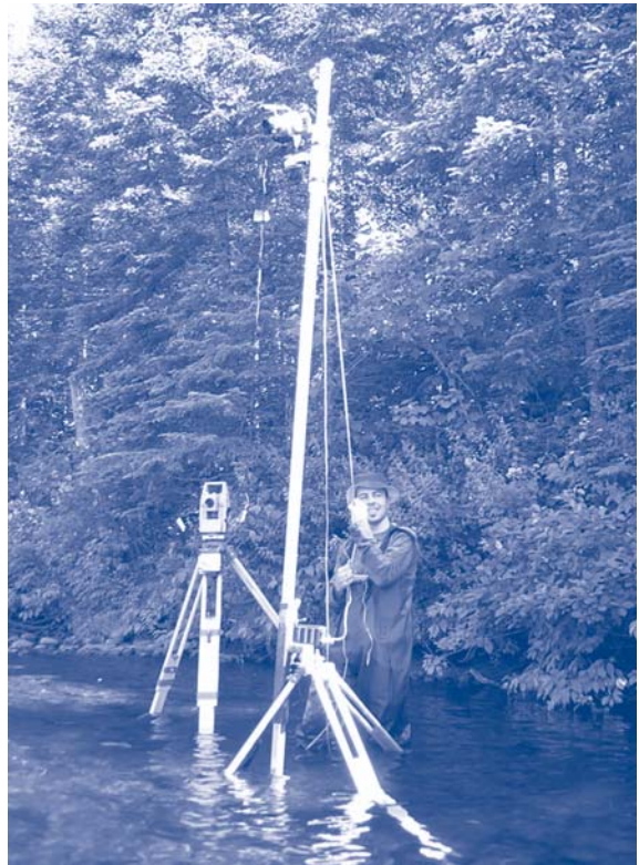
Utilisation d'une application PIV pour la mesure rapide des vitesses d'écoulement en rivière: images vidéo numériques prises en oblique de la surface de l'eau. (photo: Julie Smith)
