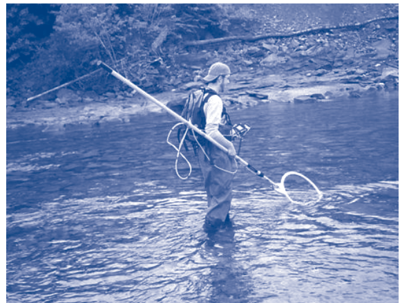
Geosalar II - Suivi des déplacements des saumons juvéniles marqués avec des PIT-tags à l'aide d'une antenne portable. (photo: Patricia Johnston)
