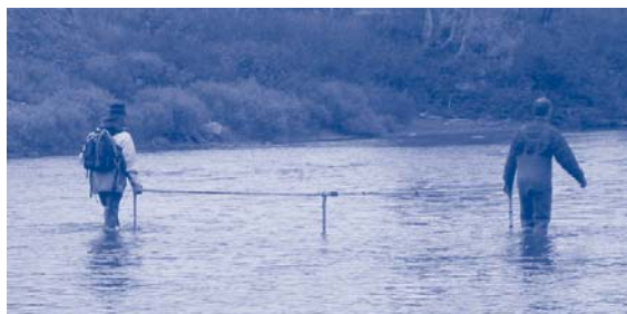
Antenne grande portée pour la détection rapide à grande échelle de poissons marqués avec des PIT-Tags. (photo: Patricia Johnston)
